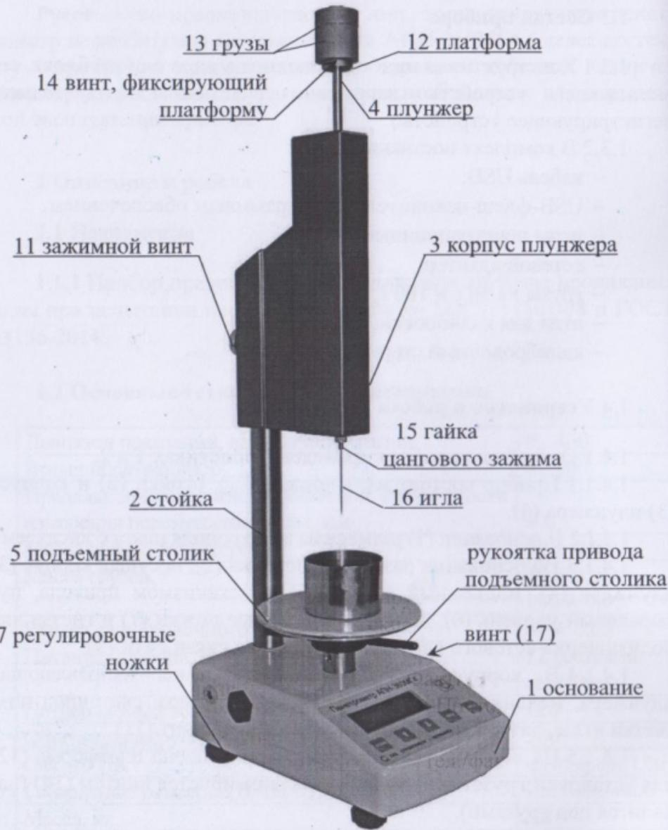
Рисунок 1 - Общий вид прибора АПН-360МГ4
