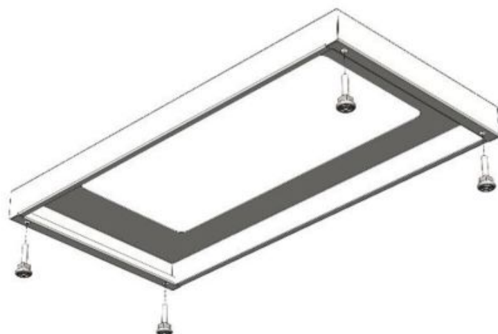
Рис. 2. Сборка низкого каркаса
