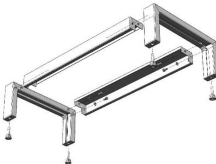
Рис. 1. Сборка высокого каркаса
