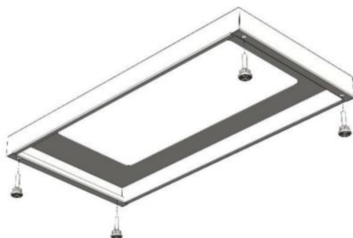
Рис. 2. Сборка низкого каркаса
