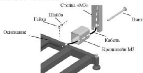
Рис. 5.3 - Крепление прямоугольной стойки к модулю ТВ-М
