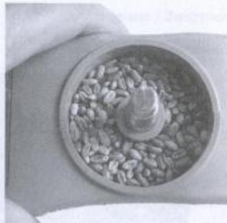
Надеть верхнюю часть измерительной ячейки и повернуть по часовой стрелке до упора.
