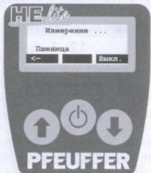
Затем дисплей отображается измеренная доля влажности выбранного продукта. Температура образца корректируется автоматически.
