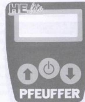
Наполните ячейку для измерения вновь, включите прибор и проведите контрольное измерение с помощью исходного образца.
