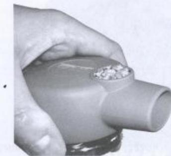
Содержимое емкости равномерно высыпать в нижнюю часть измерительной ячейки.
