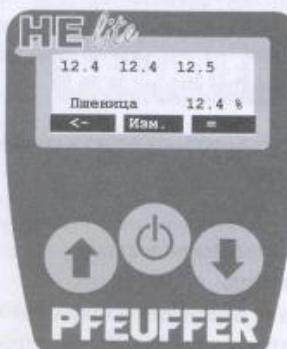
Вы можете повторить измерение произвольное количество раз. В соответствии с прежде выбранными установками прибор HE lite сохраняет данные трех последних измерений. Иными словами, после четвертого измерения среднее значение будет рассчитано из измерений 2,3 и 4, первое измерение будет стерто.
