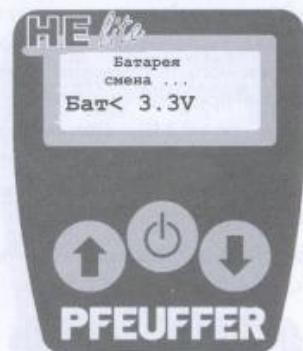
При напряжении ниже 3,3 V измерения больше невозможны, прибор HE lite выключается. Следует поменять батарейки.
