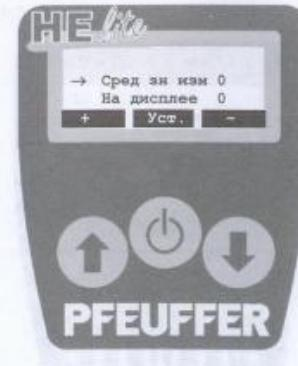
»Сред эн изм« является количеством измерений, которые должны быть включены в расчет (можно рассчитать от 1 до 6 измерений; заводская установка „0“, т.е. расчет среднего значение выключен).
