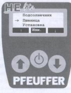
С помощью кнопок выбрать „Установка“
