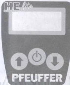
Наполните ячейку для измерения, включите прибор и проведите контрольное измерение с новыми установками.
