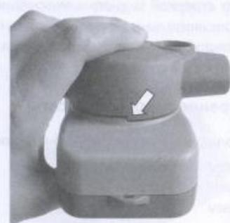
Этот уступ на измерительной ячейке показывает, что измерительная ячейка закрыта всегда одинаковоочно.
