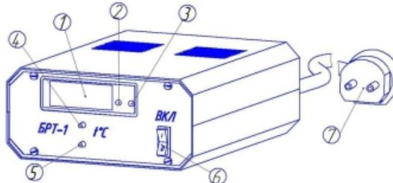
1 - цифровой индикатор температуры; 2- индикатор выхода на режим; 3- индикатор работы нагревателя; 4- кнопка увеличения уставки температуры; 5- кнопка уменьшения уставки температуры; 6- клавиша включения; 7- сетевая вилка
