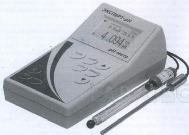
Рисунок 5.1 – Внешний вид ИП в переносном исполнении в комплекте с комбинированным pH-электродом и температурным датчиком.
