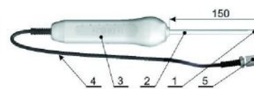
Рис. Б.17 Зонд скорости воздушного потока (ЗВСП.8)
