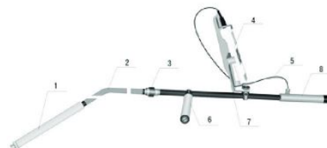
Рис. Б.7 Зонд погружаемый высокотемпературный (ЗПТВ.8)
